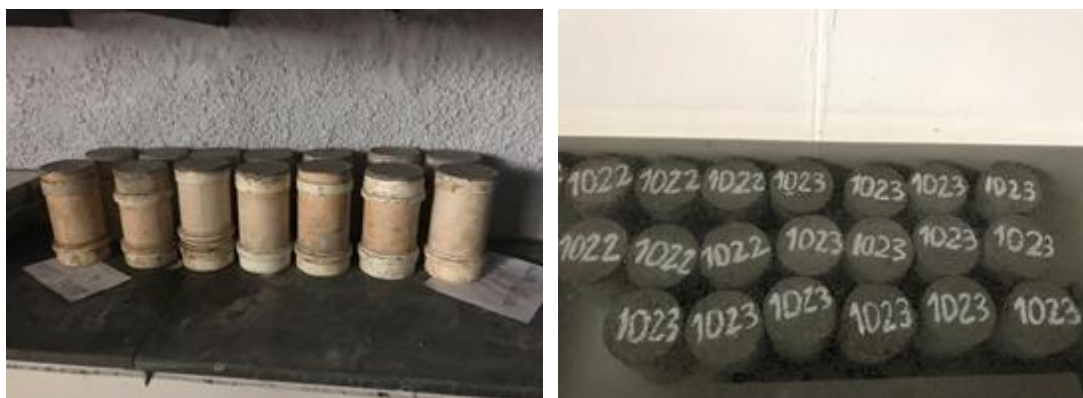
(a) (b) Figura 3 - a) Corpos de prova em fôrmas por 24 horas; b) Corpos de prova levados a cura em tanque com água após 24 horas. Fonte: próprio autor.
