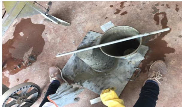
Figura 2 - Ensaio de abatimento. Fonte: próprio autor.
